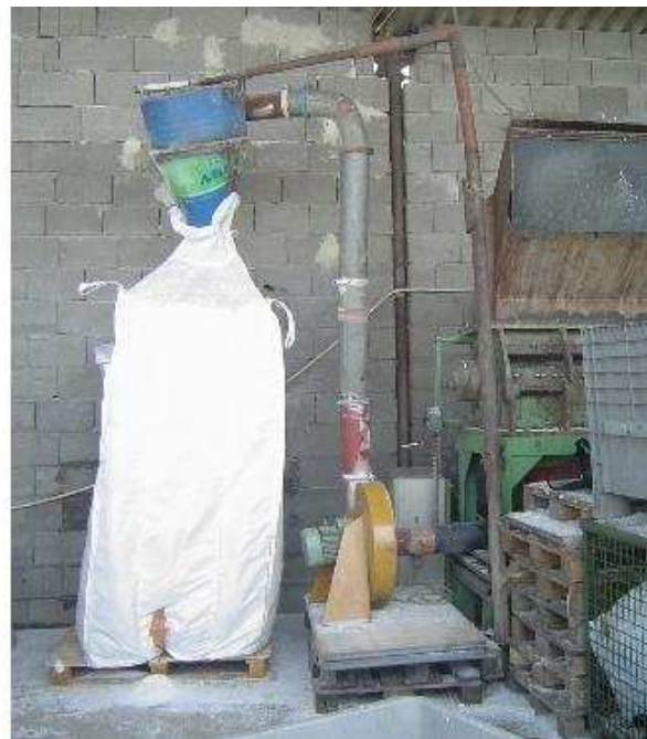
Instalație de macinare / ambalare a deșeurilor de mase plastice la SC Calex SRL Baia Mare
